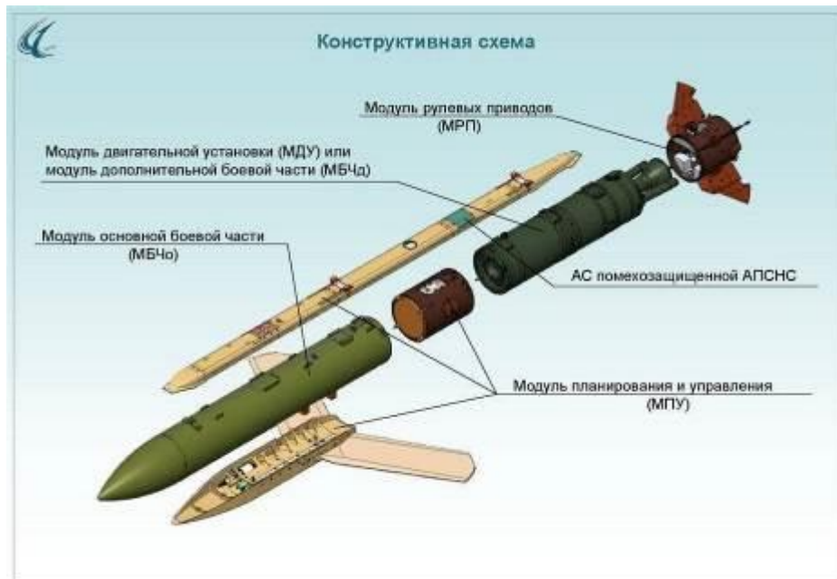
Конфигурација пројектила Grom са склапајућим крилима.
