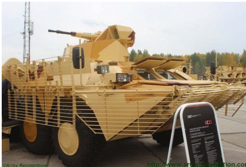
Даљински управљана оружна станица 6S21 на возилу BTR-80
