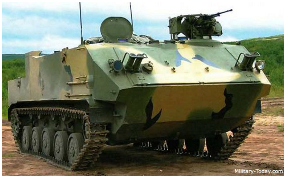
Уздигнут је простор за десантно одељење, али митраљез РКМ 7,62 мм није стабилизovan
