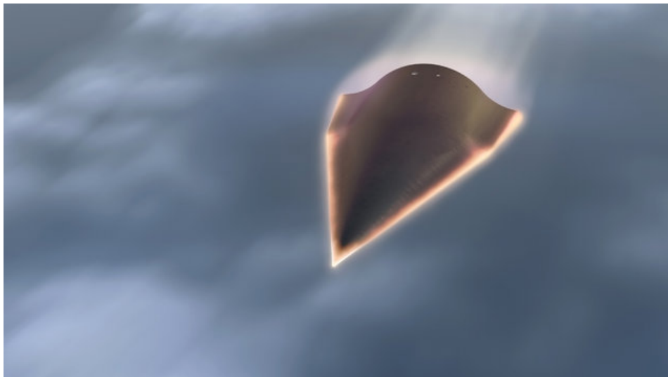
Велике температуре на нападним деловима хиперсоничног возила HSSW
