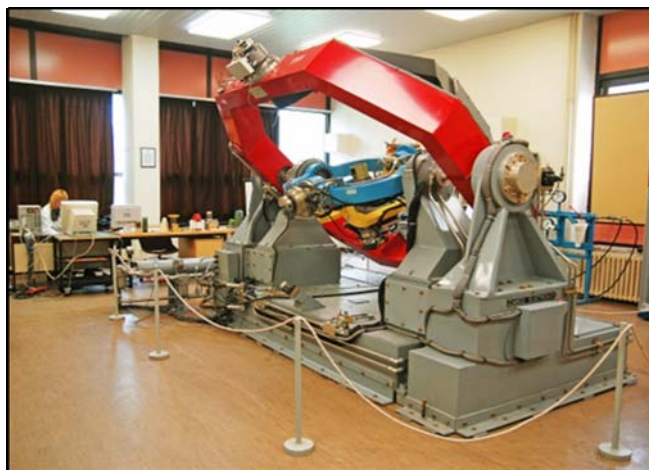
Figure 1 – HIL laboratory with five axis missile and target flight simulator Рус. 1 – ПАМ Лабораторный пятиосевой имитатор движения ракеты и цели Slika 1 – HIL laboratorija sa petoosnim simulatorom leta rakete i cilja
