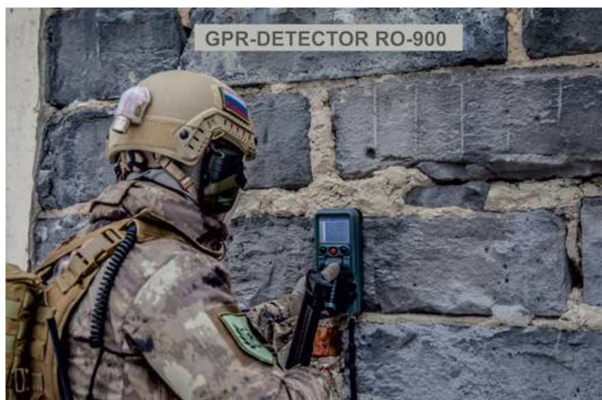
Радарски систем за откривање органских мета кроз зидове RO-900
