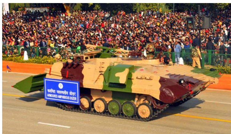
Индијски инжењеријски оклопљени амфибијски дозер развијен из основног подвоза за оклопни транспортер БРМ-II
