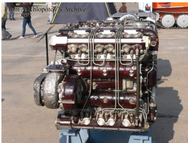
Клипни четворотактни 12-цилиндрични турбо-дизел мотор 85-3А тенка „армата“
