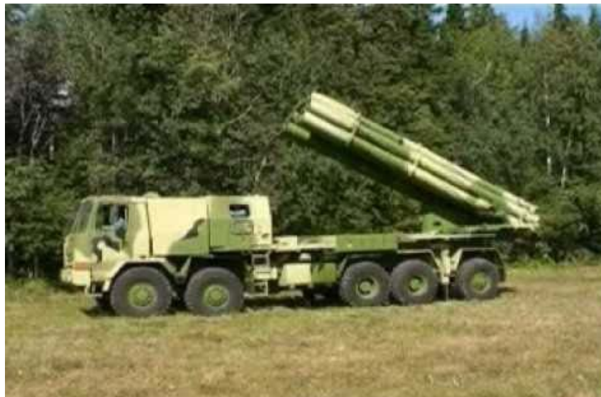
Ruski Tornado 300 mm BM 9A52 projektovan je sa novim raketama većeg dometa do 90 km, a do 120 km sa raketom 9M536
