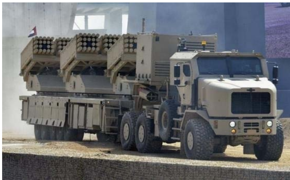
Multi Cradle Launcher/višestruki lanser sa kolevki u putnoj konfiguraciji sa prikolicom na kojoj se nalaze tri umesto četiri raketna kontejnera sa po 60 raketa od 122 mm.
