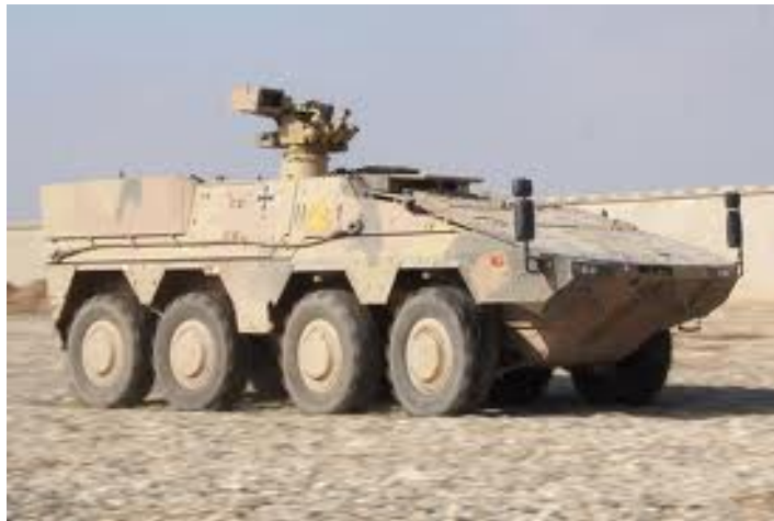
Najnovije vozilo nemačke vojske Boxer MRAP u konfiguraciji A1, u upotrebi u Avganistanu sa oružnom stanicom FLW 2000 i mitraljezom M2 HB kalibra .50
