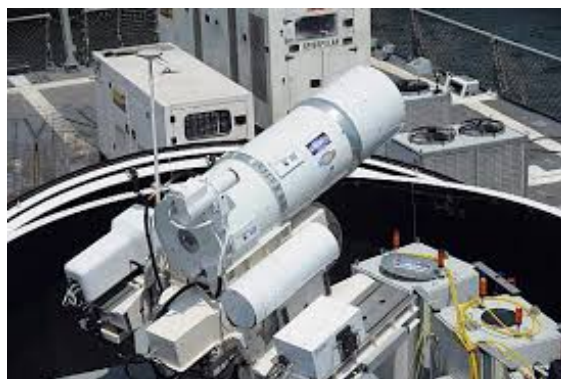
Program američke ratne mornarice LaWS upotrebljava jeftinu tehnologiju fiberoptičkih lasera kao osnov za lasersko oružje koje bi bilo integrisano na postojeću platformu Phalanx
