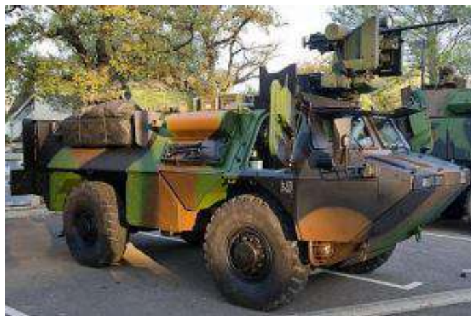
Modernizovani francuski VAB 4X4 opremljen applique pasivnim oklopom i oružnom stanicom Kongsberg Protector sa mitraljezom M2 HB kalibra .50
