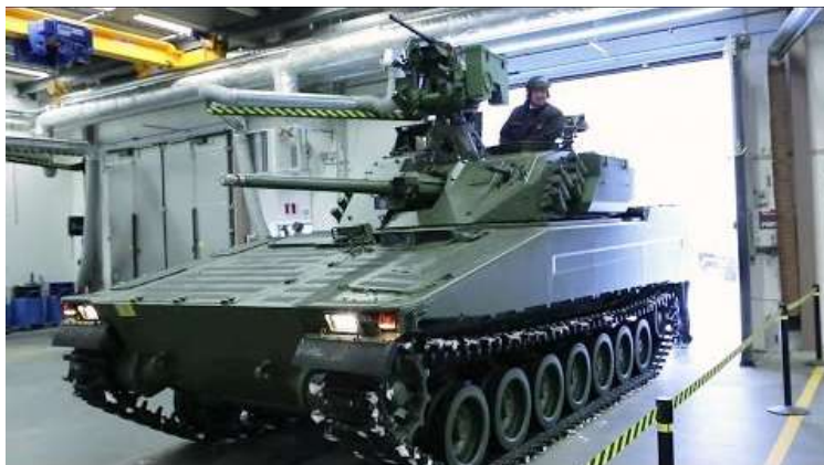
Prvi norveški CV9030N sa oružnom stanicom Konsberg Protector RWS montiranom na kupoli i naoružanom mitraljezom kalibra .50
