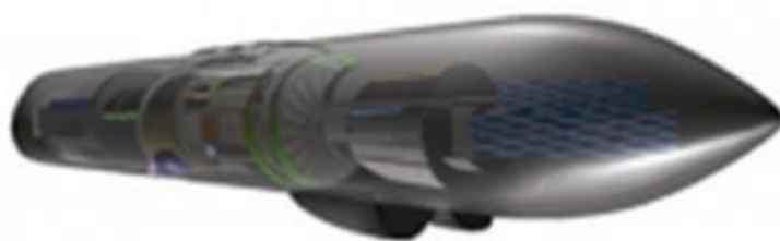
Američka verzija kontejnera za protivelektronska dejstva, za avion „Growler“, sistema koji će biti operativan 2020. godine
