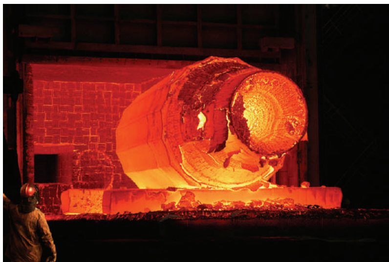
Fig. 2 – The ingot weighing 415 tons in the heat treatment furnace Slika 2 – Ingot težine 415 tona u peći za termičku obradu
