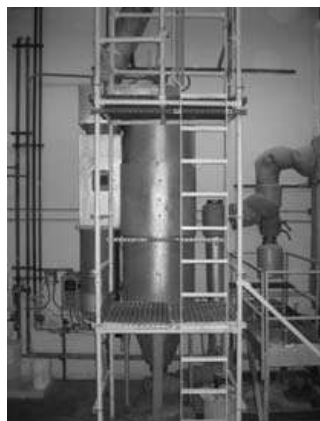
Figure 7 – Spray hydrolyser (Altair Nanomaterials Inc. Reno, Nevada) (Verlhusst et al, 2002, pp. 85-94)
