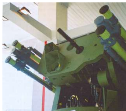
Slika: Postolje turskog sistema PVO Aselsan sa 4 rakete Igla
