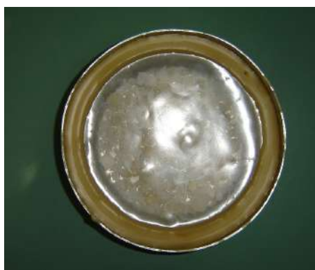
Slika 4 – Metalna posudica hermetički zatvorena uzorkom folije
