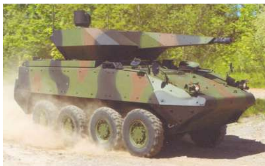
Samohodni PA top 35 mm Skyranger ugrađen na šasiju vozila Piranha III
