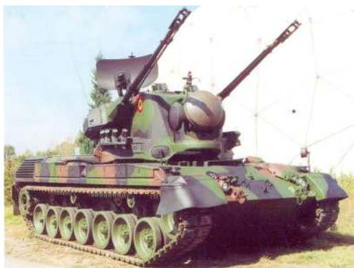
Samohodni sistem PVO Gepard s dvostrukim topom kalibra 35 mm
