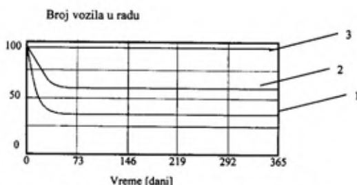
Sli. 3 – Broj ispravnih vozila u zavisnosti od kapaciteta radionice za održavanje: 1 – sa tri radna mesta; 2 – sa pet radnih mesta; 3 – sa šest radnih mesta
