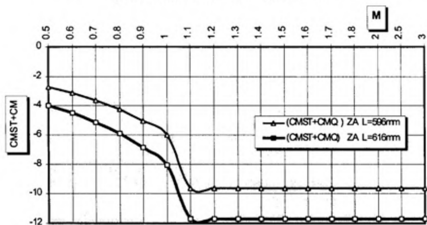
Sl. 11 – Uporedni prikaz derivativa aerodinamičkog koeficijenta (CMST + CMQ) pri vrednostima M = 0,5 - 3,0 i \alpha = 4^\circ - 10^\circ
