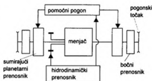
Sl. 7 – Blok-šema hidromehaničke transmisije
