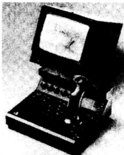
Sl. 2 – Komandna tabla sa upravljačkom palicom i monitorom nišanskog uređaja MSIS
