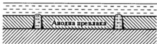
Sl. 12 – Šematski prikaz korozije anodne prevlake
