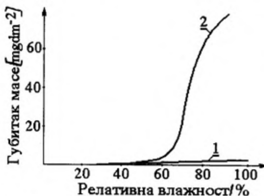
Sl. 2 – Uticaj relativne vlažnosti i zagađenosti vazduha na brzinu korozije gvožđa:
