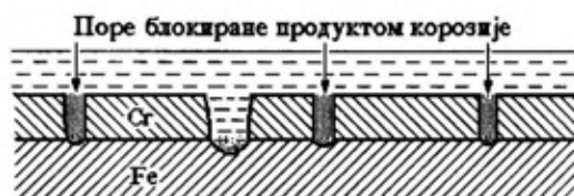
Sl. 11 – Šematski prikaz korozije gvožđa ispod hromne prevlake
