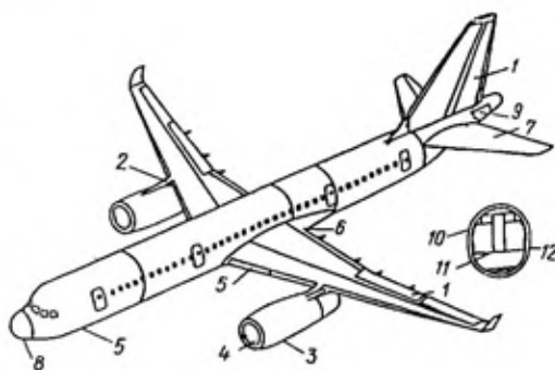
Sl. 1 – Kompozitni materijali u konstrukciji aviona Tu-204
