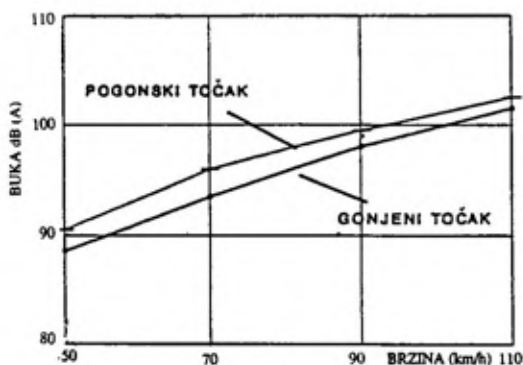
Sl. 7 — Uticaj stanja točka na buku pneumatika
