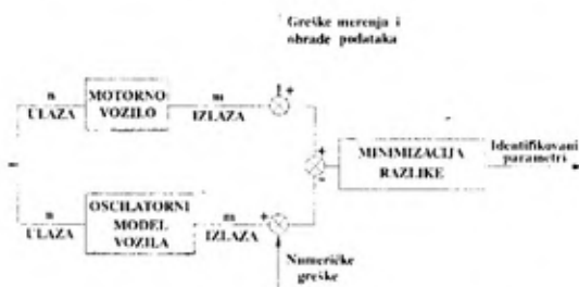
Sl. 1 — Ideja identifikacije oscilatornih parametara motornih vozila
