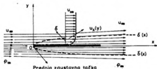
Sl. 1 — Karakteristike graničnog sloja oko ravne ploče
