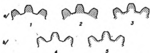
Sl. 16 — Raspored zona ojačanja pri indukcijom kaljenju:
