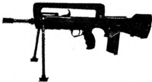
Sl. 9 — Francuska automatska puška 5,56 mm FAMAS sa sistemom »BULLUP«
