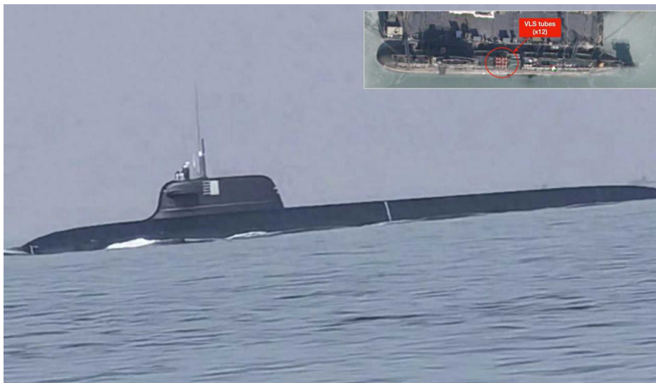
Нападна подморница на нуклеарни погон типа 093В са отвореним отворима система за вертикално лансирање (ВЛС) открива већи број лансирних цеви, што указује на знатно повећање ватрене моћи за ову класу нападах подморница
