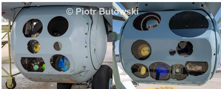
GOES-451 (лево) и модернизована електрооптичка купола GOES-451M (десно). Извор: Piotr Butowski
