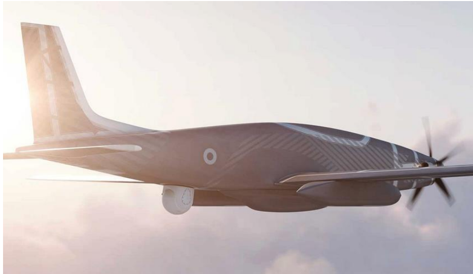
Доњи део трупа летелице опремљен је сензорском куполом
