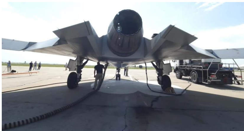
Првобитна млазница дрона која ће у наредним верзијама бити промењена ради бољих стелт карактеристика
