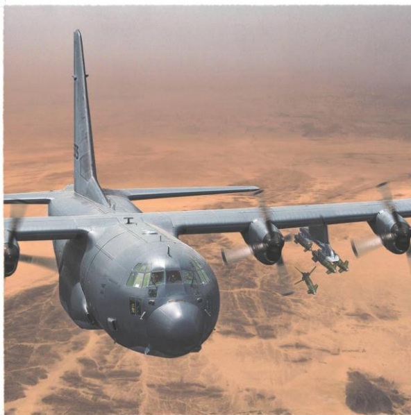
Лансери система Gerfaut за муницију AASM Hammer испод крила транспортног авиона C-130 Hercules
