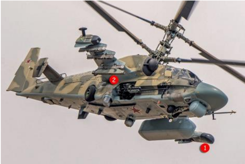
Први модернизовани хеликоптер Ка-52М опремљен контејнером са даталинком AS-BPLA (1) и шинским лансером APU-305 (2) за ракете LMUR
