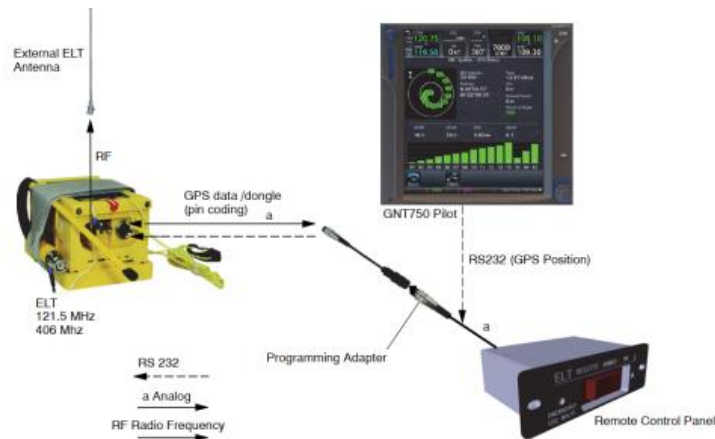
Figure 4 – Components of the ELT device Рис. 4 – Компоненты устройства ELT Слика 4 – Саставни елементи ELT уређаја (in Serbian)
