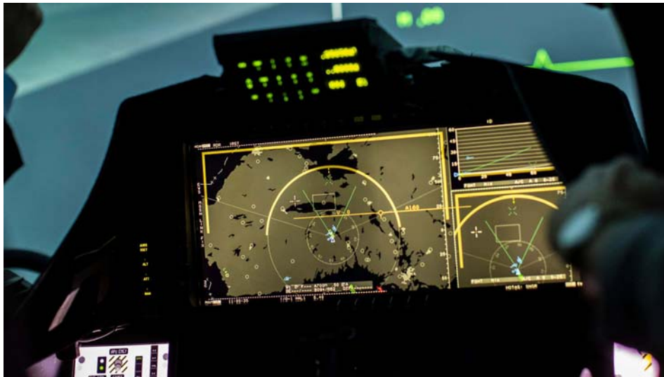
Wide Area Display/ централни дисплеј ловца Gripen E
