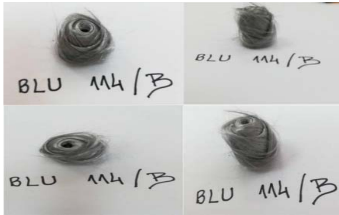
Figure 6 – Samples for the analysis – a separate spool of fibers from a cluster bomblet (Serbian Armed Forces, 1999) Рис. 6 – Образцы для анализа – извлеченная из кассетной бомбы волоконная катушка (Serbian Armed Forces, 1999) Слика 6 – Узорци за анализу – издвојен намотај влакана из касетне бомбице (Serbian Armed Forces, 1999)
