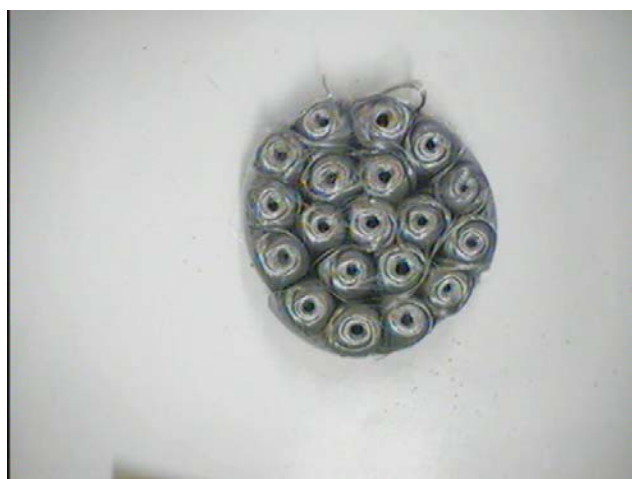
Figure 3 – Arrangement of spools in the bomblet, top view (Serbian Armed Forces, 1999) Рис. 3 – Расположение катушек в бомбе малого калибра, вид сверху (Serbian Armed Forces, 1999)
