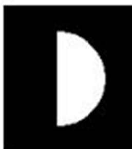
Figure 7 – Step-target, used in the MTF measurement Рис. 7 – Целевой тест, используемый при измерении МТФ Слика 7 – Тест-мета која се користи за мерење МТФ-а
