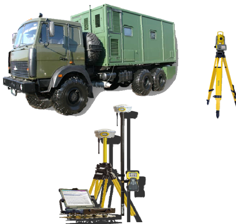
Figure 4 – Mobile navigation and geodetic complex Рис. 4 – Подвижный навигационно-геодезический комплекс Слика 4 – Мобилна навигација и геодезски комплет
