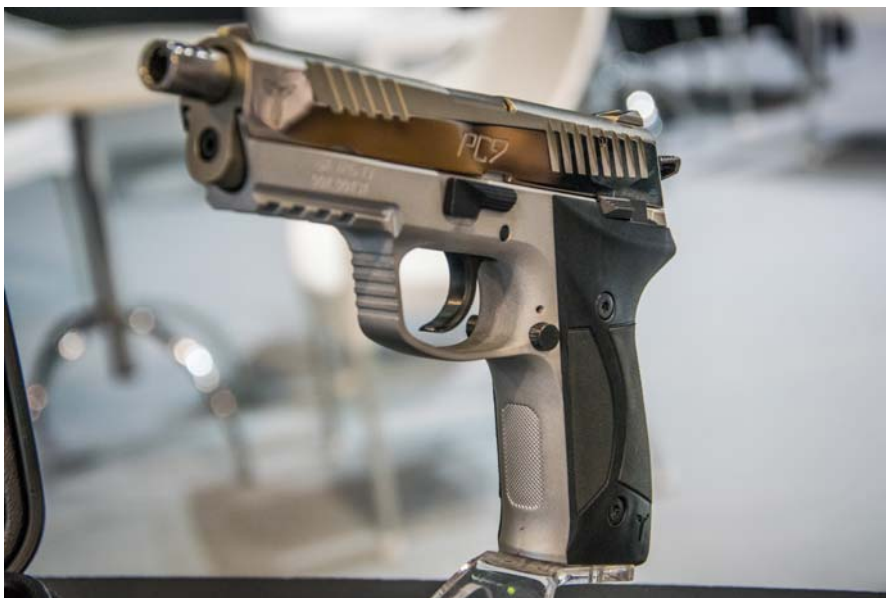
Модел са навојем за монтирање пригушивача пуцња. Фото: Милош Јевтић
