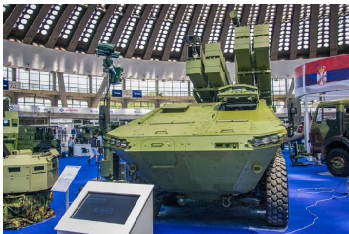
Противтенковски систем „РАЛАС”, монтиран на вишенаменско возило 8×8 из серије „Лазар”, произвођача „Југоимпорт СДПР”. Фото: Милош Јевтић
