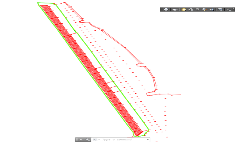
Figure 9 – Separation of the data based on which the DMT is formed Рис. 9 – Выделение данных на основании которых создается ЦММ Слика 9 – Издвајање података на основу којих се формира ДМТ
