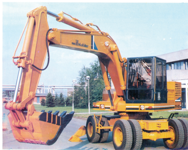
Figure 1 – Physical model of a hydraulic BTH-600 excavator: 1 - undercarriage (pneumatics), 2 - rotary link (platform), 3 - boom, 4 - arm (stick), 5 - bucket Рис. 1 – Механическая модель гидравлического экскаватора BTH-600: – пневмоколесное ходовое устройство, 2 – поворотная платформа 3 – стрела, 4 – рукоять, 5 – ковш
