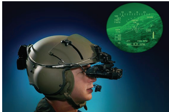
Figure 10 – ANVIS HUD with the head-up display Рис. 10 – ANVIS HUD с наплемным целеуказателем Слика 10 – ANVIS HUD са head-up дисплејом
