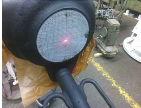
Figure 10 – Laser beam directed at the center of the circular mesh Рис. 10 – Изображение лазерного целеуказателя, направленного в центр прицельной сетки Слика 10 – Приказ ласерског снопа усмереног у центар кружне мреже
