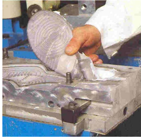
12– Removing the sole from the tool Рис. 12 – Извлечение подошвы из формы Слика 12 – Вађење ђона из алата
