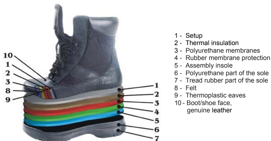
Figure 1 – Components of shoes (boots) Рис. 1 – Составные части обуви (ботинка) Слика 1 – Саставни делови обуће (чизме)
