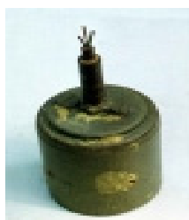
Figure 20 –PP Mi-Sr II mine Рус. 20 – Мина РР Ми-Ср II Слика 20 – Мина РР Ми-Ср II
