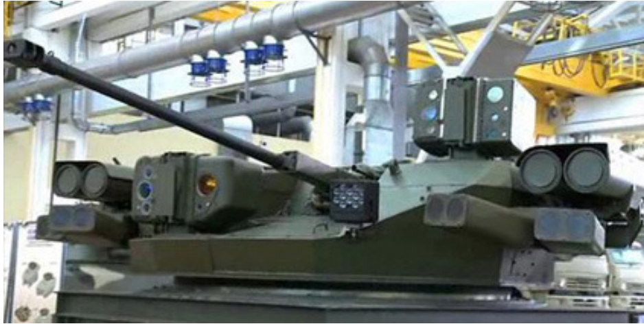
Руска купола Epoch Almaty опремљена потпуно стабилованим топом 30 мм 2А42
