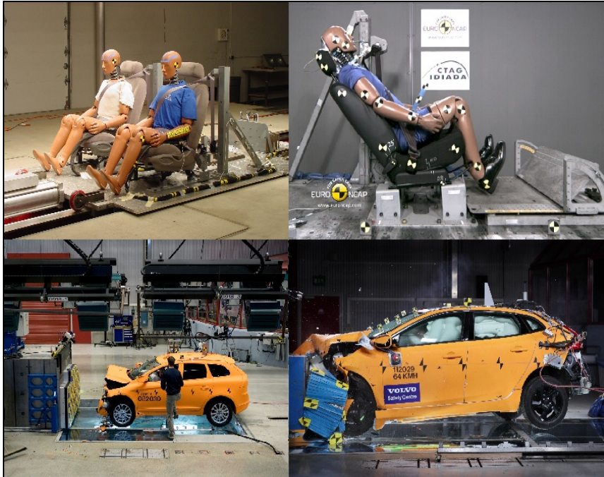
Figure 7 – Simulation of occupants in crash tests and tests of safety belts Рис. 7 – Моделирование поведения пассажиров в краш-тестах и при испытаниях ремня безопасности Слика 7 – Симулирање понашања путника у тестовима удеса и тестовима безбедности система за заустављање
