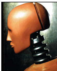
Figure 8 – Neck for crash-test dummies Рис. 8 – Шея манекенов, используемых в дорожно-транспортных краш-тестах Слика 8 – Врат за лутке које се користе при тестирању саобраћајних несрећа
