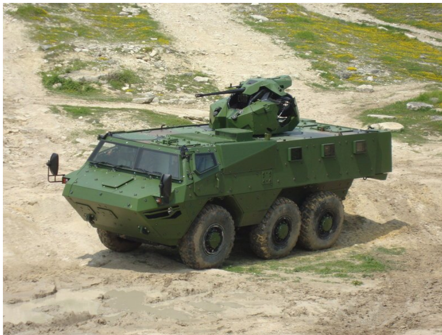
Верзија куполе наоружана топом 25 мм компаније Orbital ATK Armament Systems на француском борбеном возилу пешадије VAB Mk 3 у конфигурацији 6x6
