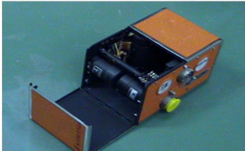
Figure 4 – A20 photo recorder (Arhiv Vazduhoplovnog opitnog centra, 2016) Рисунок 4 – Фоторегистратор А-20 (Архив Ваздухопловног опитног центра, 2016) Слика 4 – Фото-регистратор А-20 (Архив Ваздухопловног опитног центра, 2016)
