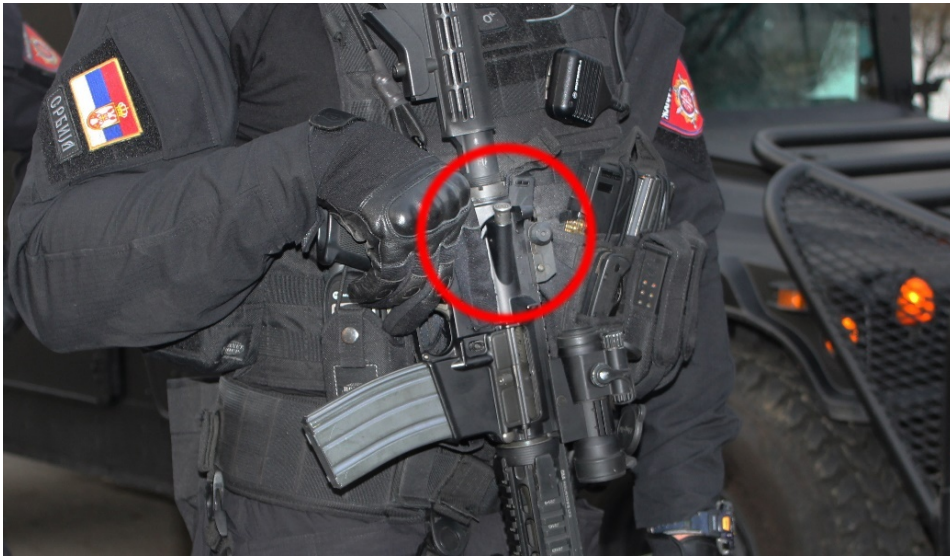
Потискивач затварача на карабину „Colt M-4 A4 Commando” у калибру 5,56 мм, припадника Прве специјалистичке јединице Жандармерије Републике Србије Фото: Милош Јевтић
