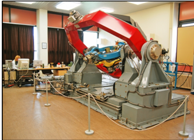
Figure 1 – HIL laboratory with five axis missile and target flight simulator Рус. 1 – ПАМ Лабораторный пятиосевой имитатор движения ракеты и цели Slika 1 – HIL laboratorija sa petoosnim simulatorom leta rakete i cilja
