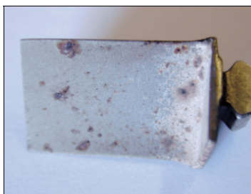
Slika 10 – Piting korozija na HH-3F kompresorskoj lopatici Рус. 10 – Точечная коррозия на компрессорной лопатке HH-3F Figure 10 – Pitting corrosion on a HH-3F compressor blade
