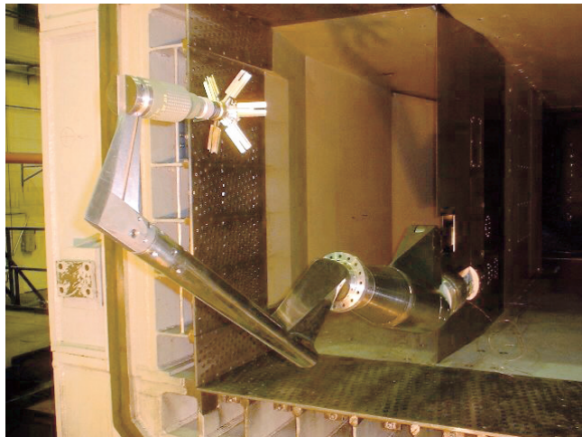
Slika 4 – Test model PTAB na lomljenom stingu Рус. 4 – Тестовая модель ПТАБ на кривой державке Figure 4 – PTAB test model on a broken sting
