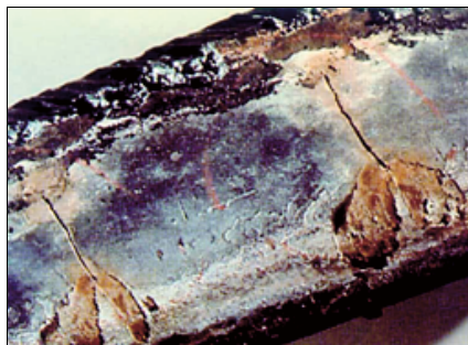
Slika 20 – Transkristalna prskotina nastala kao posledica naponske korozije (oštra je i prava) Рис. 20 – Трещина в результате коррозионного напряжения. Острая трещина с ровными краями. Транскристаллитная трещина Figure 20 – Crack as a result of stress corrosion. The crack is sharp and straight – transgranular crack
