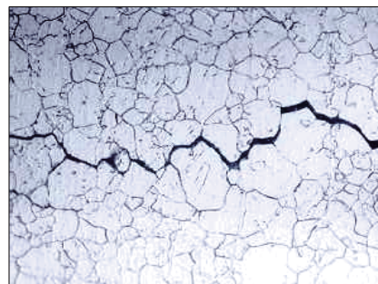
Slika 21 – Interkristalna prskotina nastala usled naponske korozije (x500 Inconel). Рис. 21 – Межкристаллитное коррозионное растрескивание под напряжением (x500 Inconel) Figure 21 – Intergranular stress corrosion cracking (x500 Inconel).
