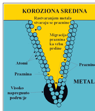
Slika 18 – Šematski prikaz mehanizma rastvaranja metala potpomognutog mehaničkim dejstvom
