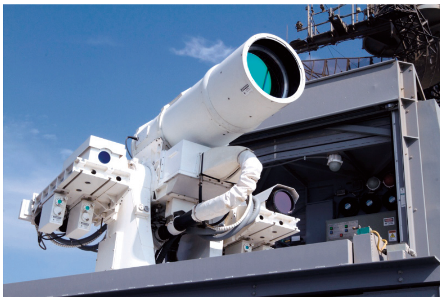
Ласерски систем снаге 30 килвата који се налази на војном броду USS Ponce
