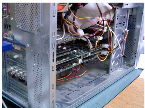
Sl. 5 – Digitalni deo prijemnika LPI signala
