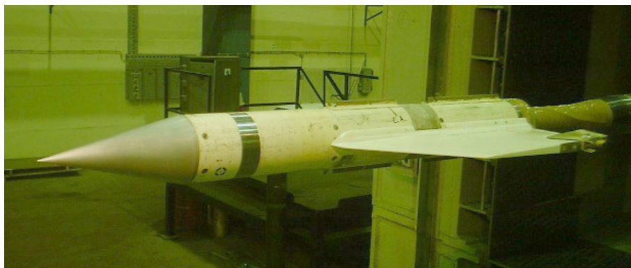
Sl. 2 – Eksperimentalni model sa roleronom u radnom delu aerotunela T-38
