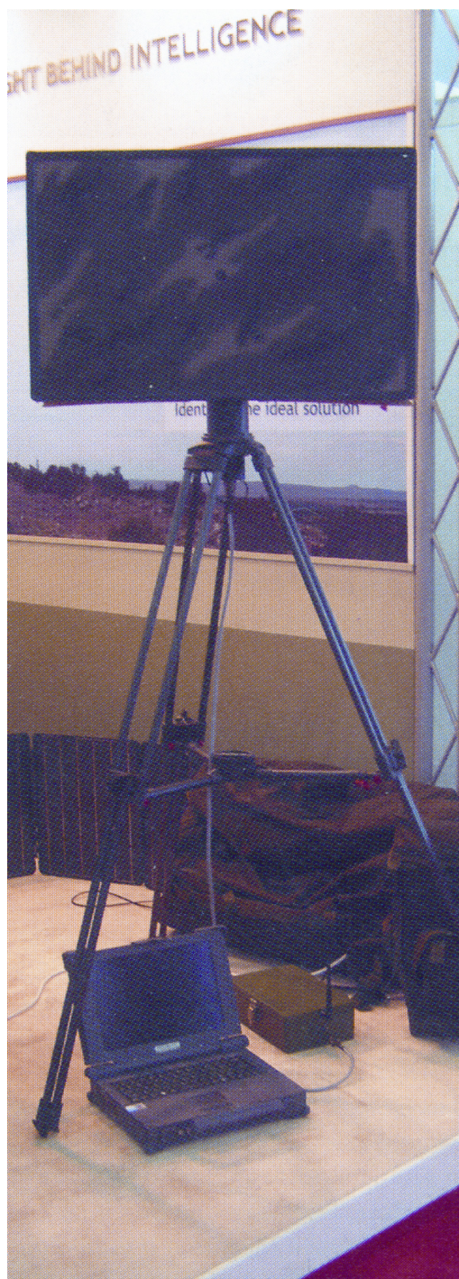
Borbeni osmatrački radar Propatria PGRS-2 FMCW u standardnoj konfiguraciji
