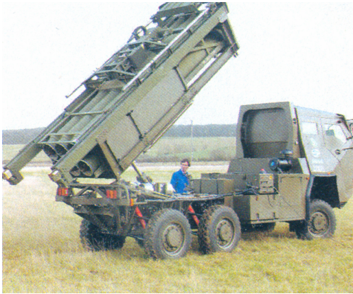
Laki artiljerijski raketni sistem LIMAWS(R) na vozilu HMT 6×4
