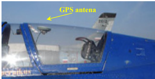
Sl. 6 – Antena GPS System 1200, Leica na avionu G-2A
