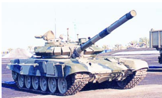
Ruski poboljšani tenk T-72 M1 može da se opremi glatkocevnim topom 120 mm M-395
