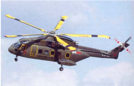
Probni helikopter US 101, opremljen najnovijim krilima glavnog rotora i motorima CT7-8E na svom prvom letu
