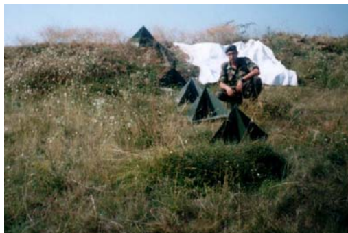
Sl. 2 – Grupa od 6 „velikih“ linijski postavljenih uglovnih reflektora
