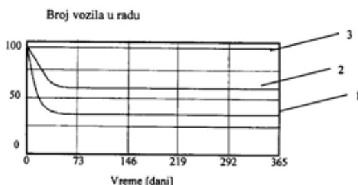
Sl. 3 – Broj ispravnih vozila u zavisnosti od kapaciteta radionice za održavanje: 1 – sa tri radna mesta; 2 – sa pet radnih mesta; 3 – sa šest radnih mesta
