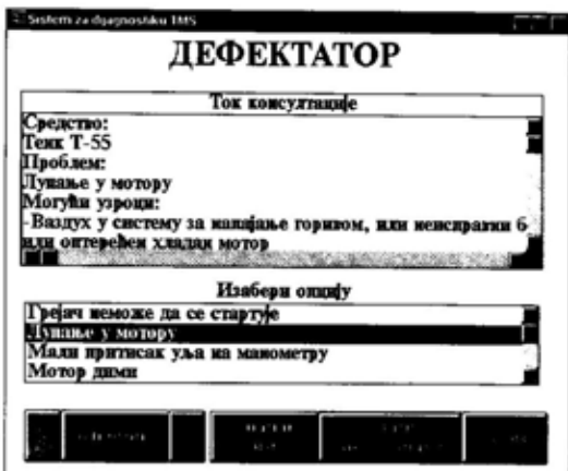
Sl. 9 – Izbor neispravnosti i defekataža za tenk T-55
