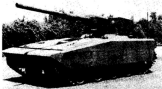
Sl. 2 – Eksperimentalni tenk sa topom montiranim sa spoljašnje strane
