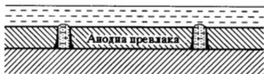
Sl. 12 – Šematski prikaz korozije anodne prevlake
