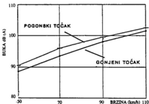
Sl. 7 — Uticaj stanja točka na buku pneumatika
