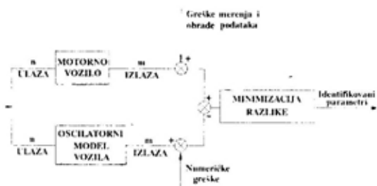
Sl. 1 — Ideja identifikacije oscilatornih parametara motornih vozila
