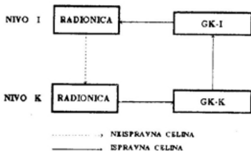
Sli. 1 — Tok popravljivih modularnih celina
