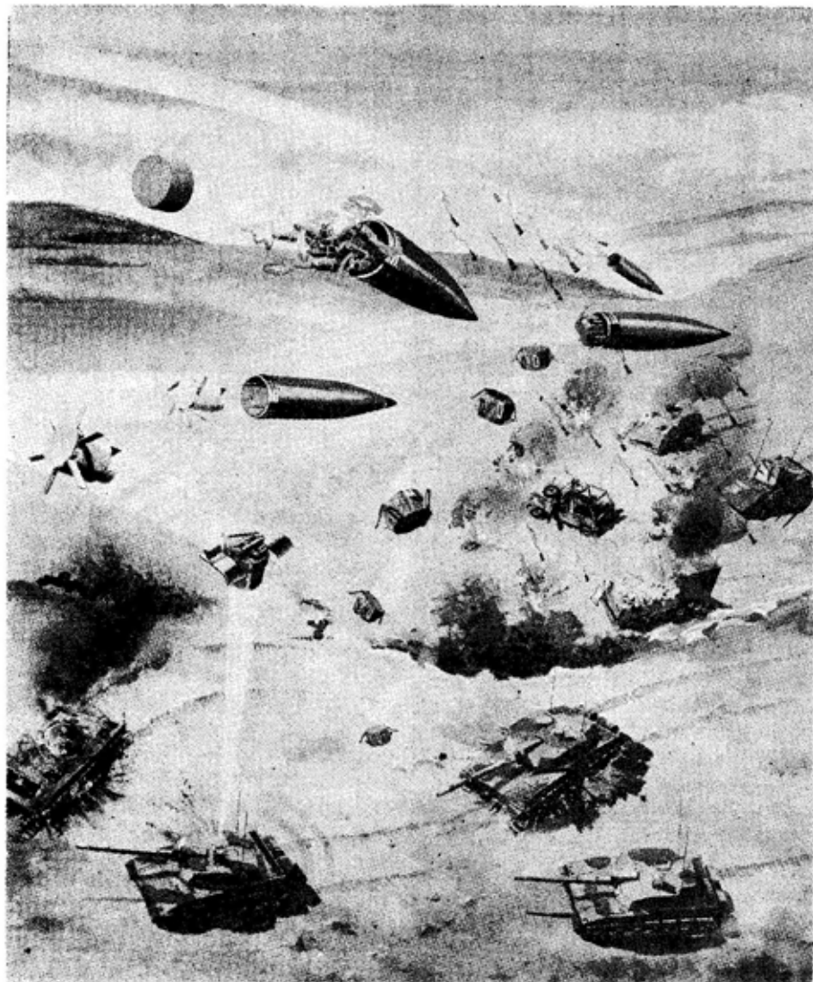
Sl. 2 — Princip dejstva SMART municije
