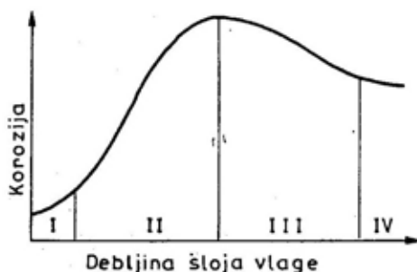
Sl. 3 — Zavisnost brzine korozije gvožđa od debljine sloja vlage na površini metala
