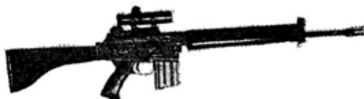
Sl. 2 — Engleska automatska puška 5,56 mm AR-18
