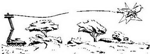
Sl. 3 — Sistem PVO/PTO sa lanserom, koji se nalazi na platformi hidraulične dizalice
