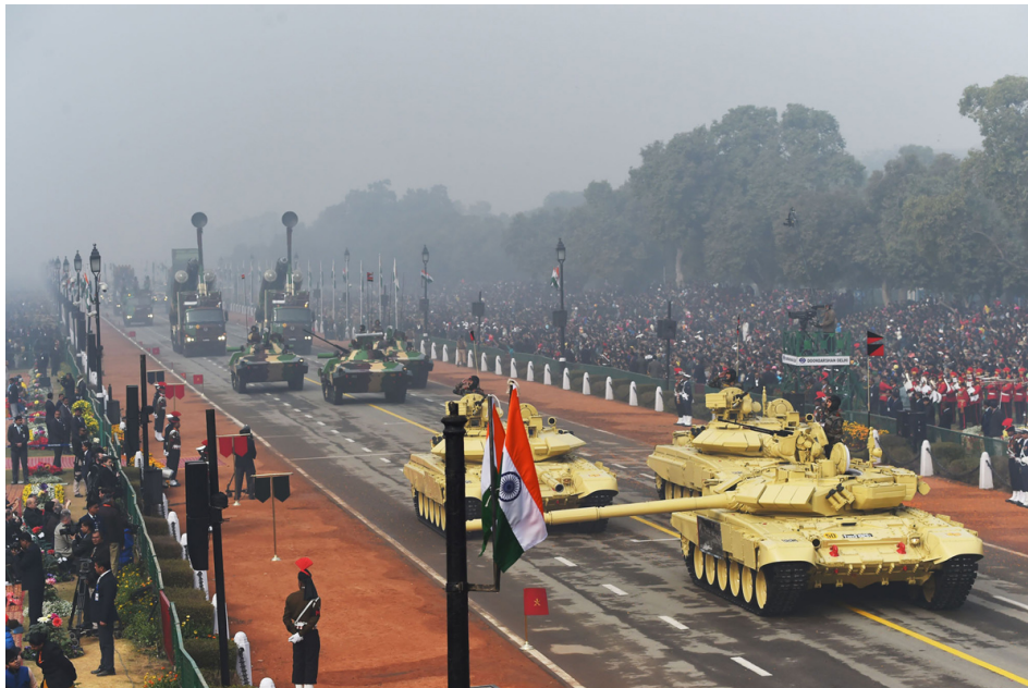
Индијски тенк „Бишма” наоружан је топом 2А46М-1 са ожељбљеном цеви 125 мм
