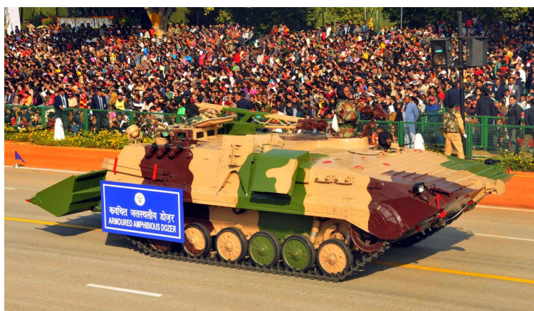
Индијски инжењеријски оклопљени амфибијски дозер развијен из основног подвоза за оклопни транспортер БМ-ИИ
