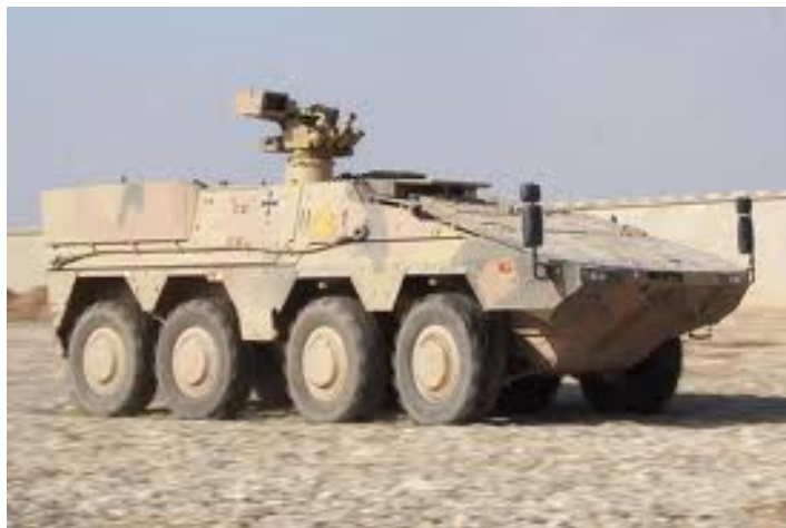
Najnovije vozilo nemačke vojske Boxer MRV u konfiguraciji A1 , u upotrebi u Avganistanu sa oružnom stanicom FLW 2000 i mitraljezom M2 HB kalibra .50
